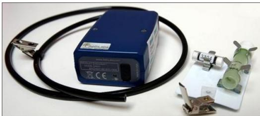
Voici quelques-uns des appareils de mesure qu'utilise Mathilde au cours de la semaine. Il s'agit de l'AE 51, le boîtier bleu avec la sonde, ainsi que les capteurs passifs. Photo Le DU/Marc GREINER
